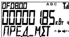
Рисунок 2.7 – Меню 1 Кадр 6. Энергия активная нарастающим итогом всего за предыдущий месяц, в кВт·ч
